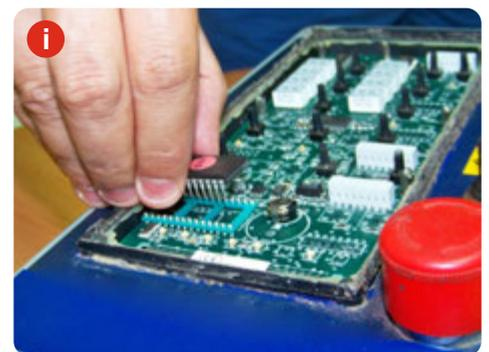
4. Colocaremos el nuevo microprocesador con extrema precaución, pues si se rompe o dobla alguna de las "patas", éste puede quedar inutilizable y debería sustituirse por otro.
