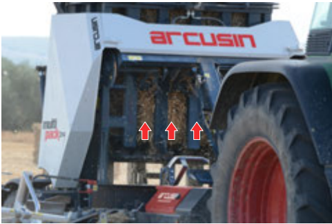
Chambre de compactage
