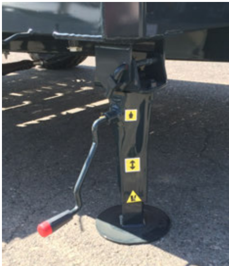
Stützfuß nach unten geklappt
