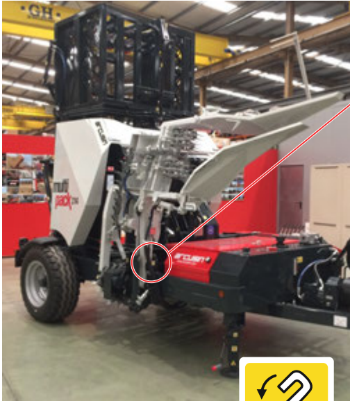
Pick up in Transport Position (hochgeklappt)
