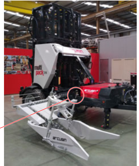
Pick up in Arbeitsposition (abgesenkt)
