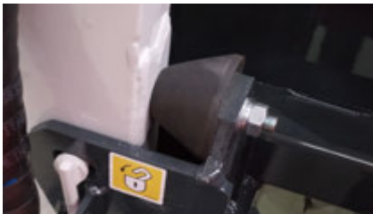
DÄMPFUNGSBLOCK RICHTIG MONTIERT
